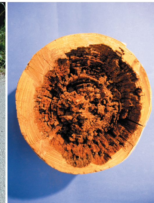
Trykimprægneret stolpe i fyr. Splinttræet har opnået en større holdbarhed en kerneveddet.
